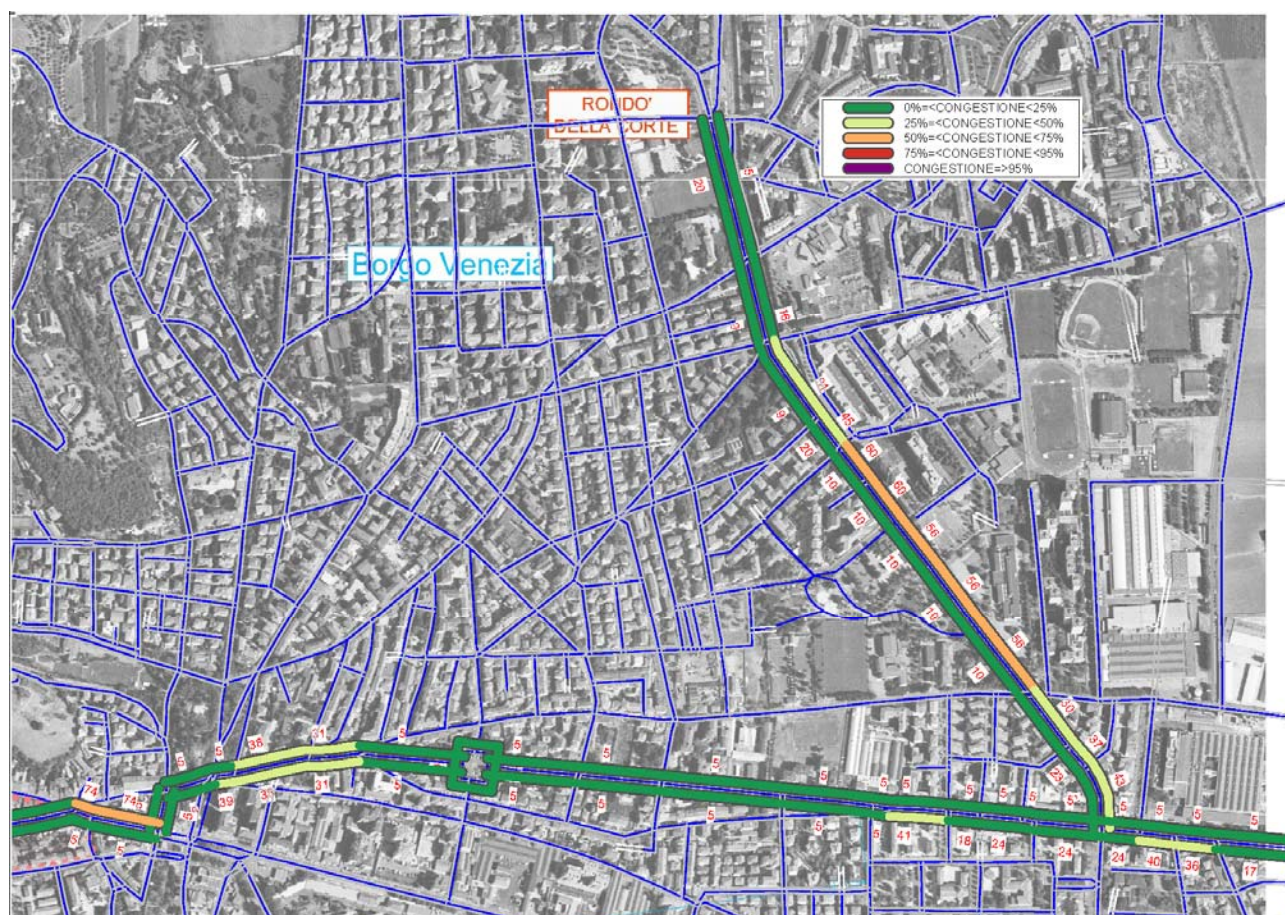
Figura 8 – grado di congestione sulla LINEA 1B: Tratta Rondò della Corte - Via Mondadori
